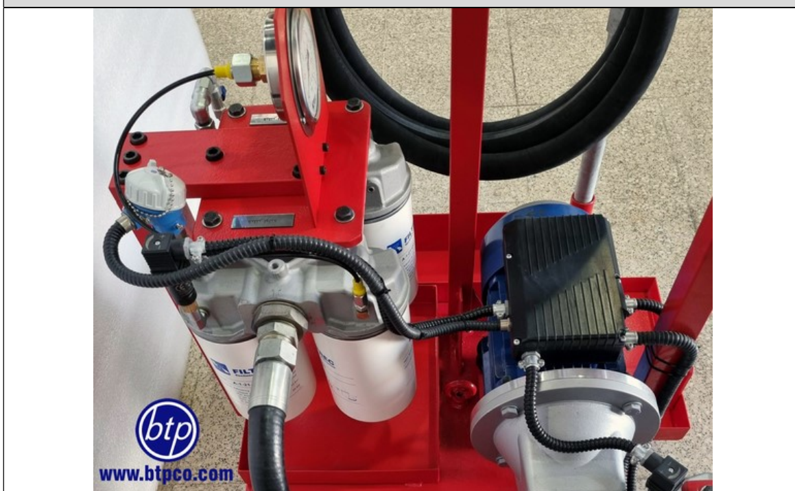
دستگاه SFC100 شامل هد دوبل در ورودی و خروجی
