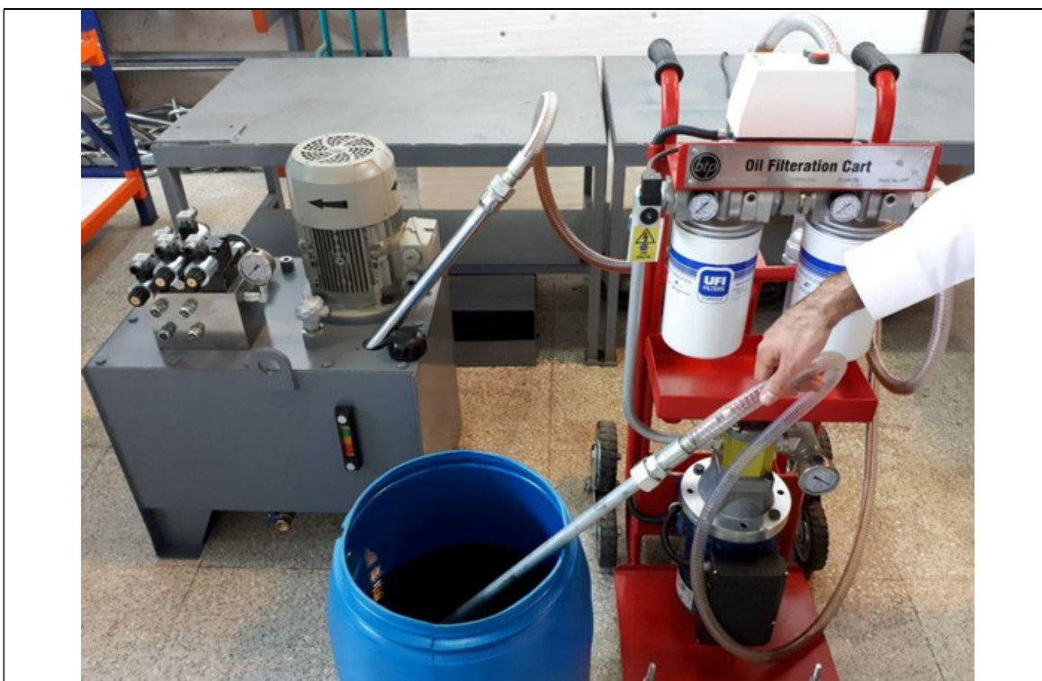
قرار گیری لوله مکش و فشار داخل مخزن و بشکه
