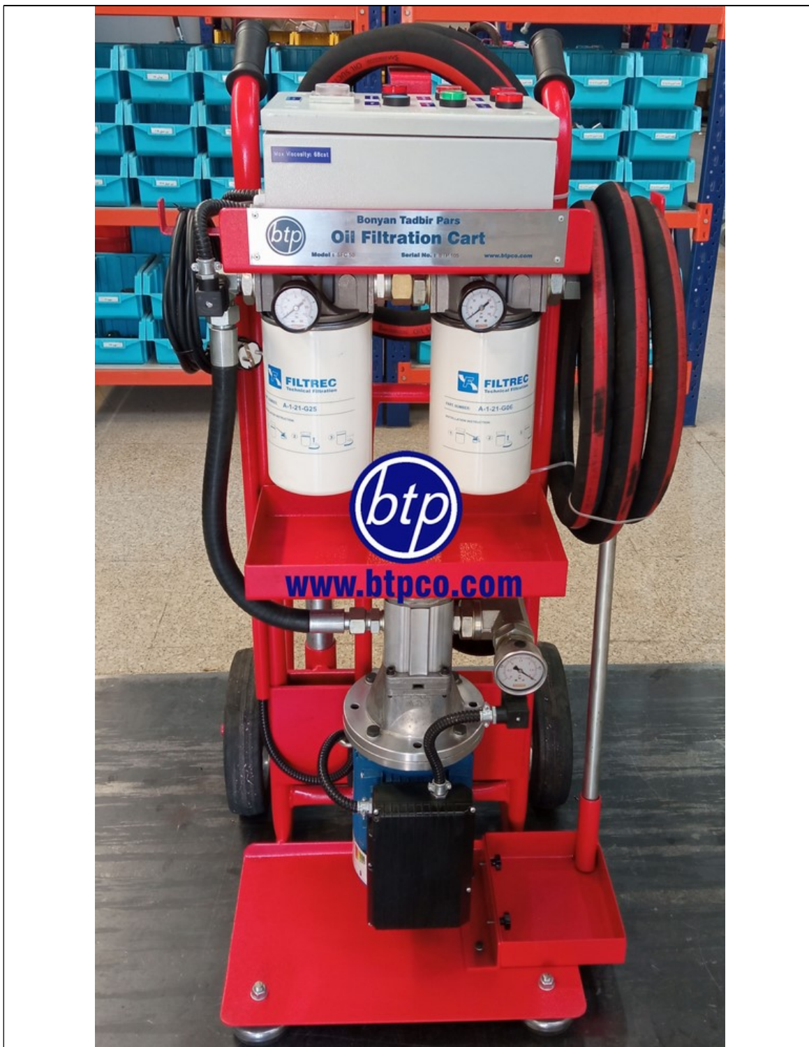
دستگاه SFC50 دارای دو فیلتر خروجی و یک فیلتر ورودی
