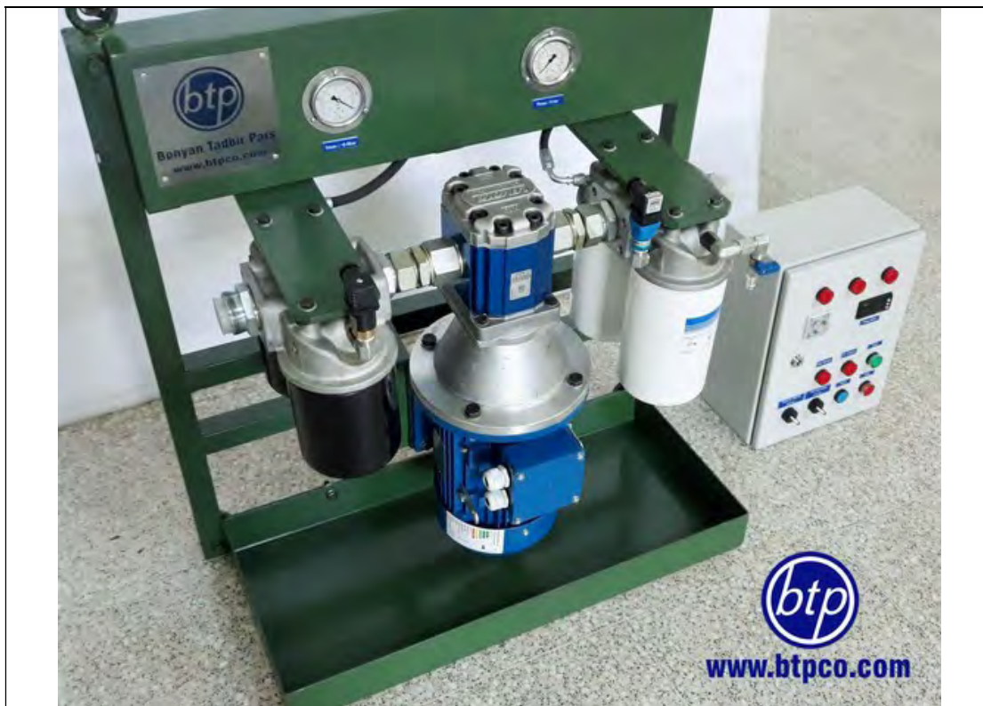
سیستم فیکس فیلتراسیون روغن دارای چهار مجموعه فیلتر با دبی 92lit/min صنعت تولید لوازم آشپزخانه
