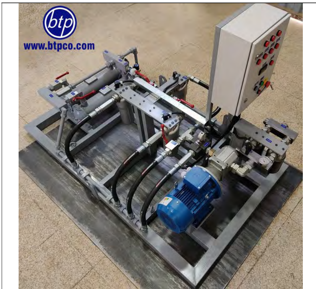
سیستم فیکس فیلتراسیون روغن هیدرولیک دارای سه مجموعه فیلتر با دبی 100lit/min صنعت فولاد
