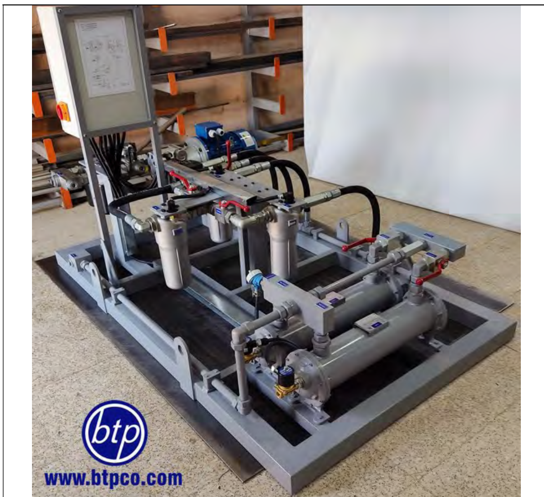
سیستم فیکس فیلتراسیون و خنک کن کاری روغن هیدرولیک صنعت فولاد
