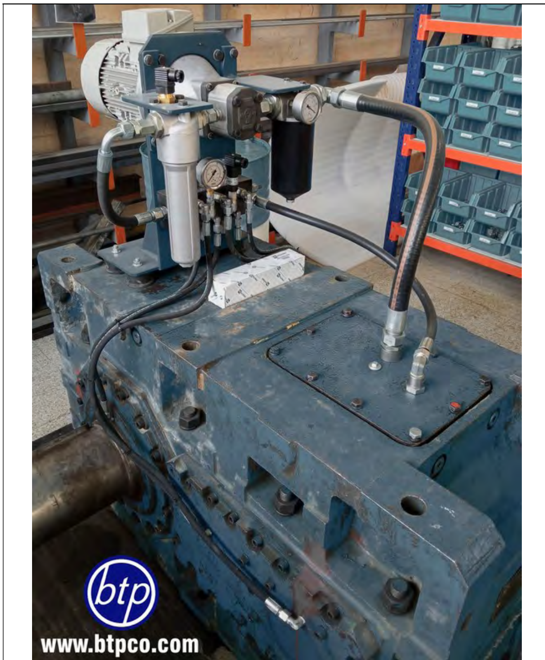
سیستم فیکس فیلتراسیون روغن Hi-Viscosity گیربکس انتقال مواد معدنی دارای دو مجموعه فیلتر با دبی 10lit/min - صنایع معدنی
