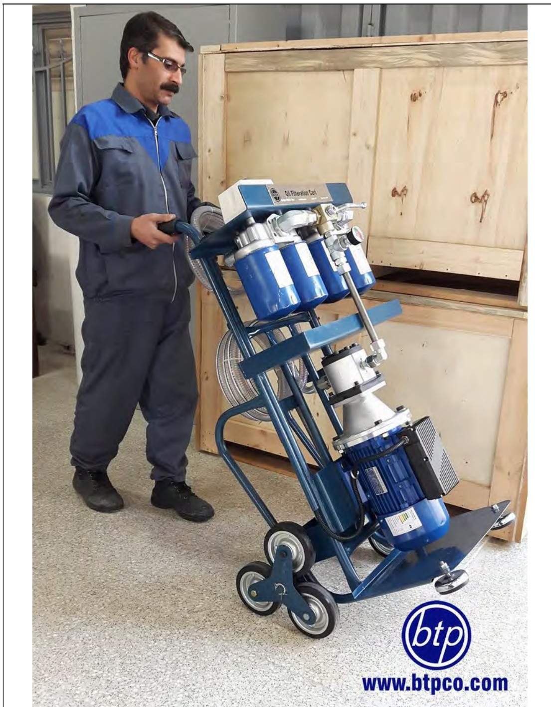
سیستم پرتابل فیلتراسیون دارای چهار مجموعه فیلتر و شیر سه راهه جهت سوئیچ از مجموعه یک به دو با دبی 60lit/min - صنعت فولاد
