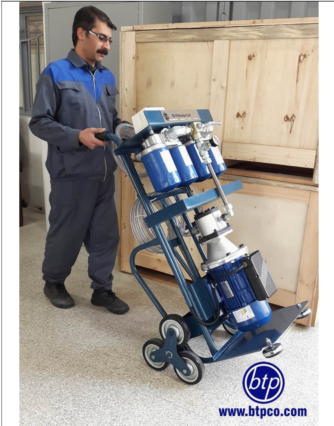
سیستم پرتابل فیلتراسیون دارای چهار مجموعه فیلتر و شیر سه راهه جهت سوئیچ از مجموعه یک به دو با دبی 60lit/min
