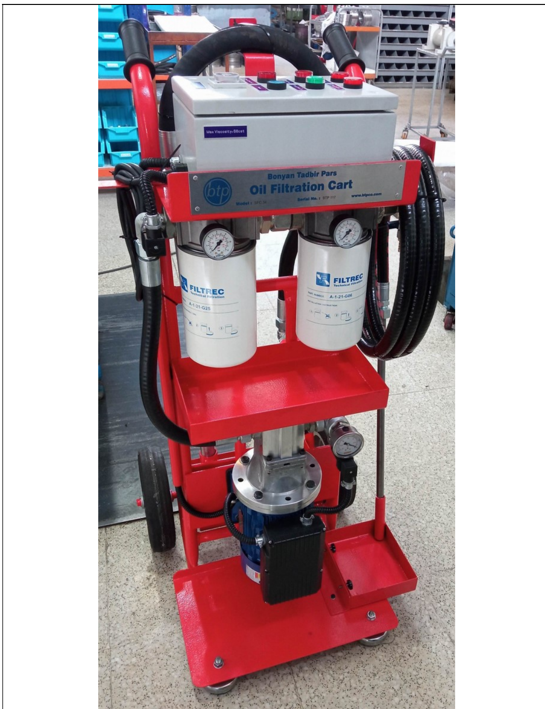
فیلتر کارت سری SFC34 ( دو فیلتره ) دارای دو فیلتر خروجی و یک فیلتر ورودی
