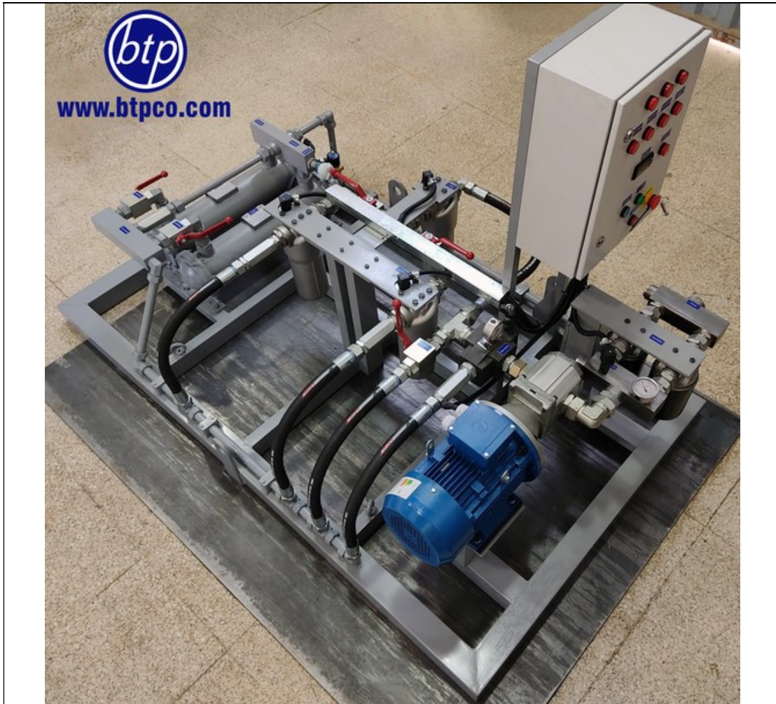
سیستم فیکس فیلتراسیون روغن هیدرولیک دارای سه مجموعه فیلتر با دبی 100lit/min
