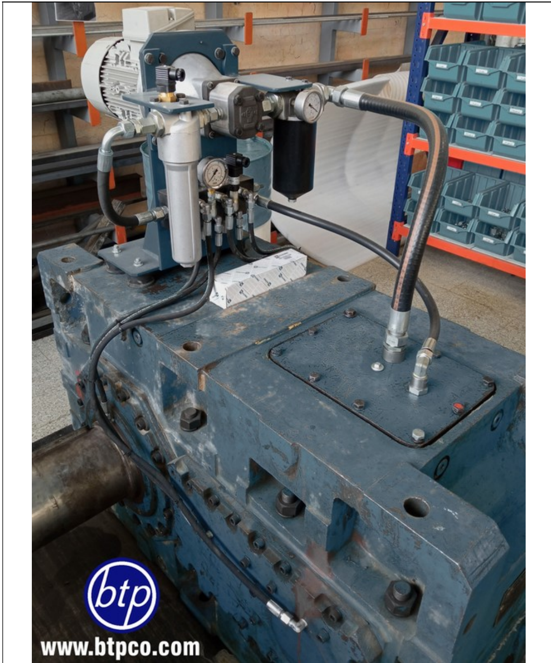
سیستم فیکس فیلتراسیون روغن Hi-Viscosity گیربکس انتقال مواد معدنی دارای دو مجموعه فیلتر با دبی 10lit/min
