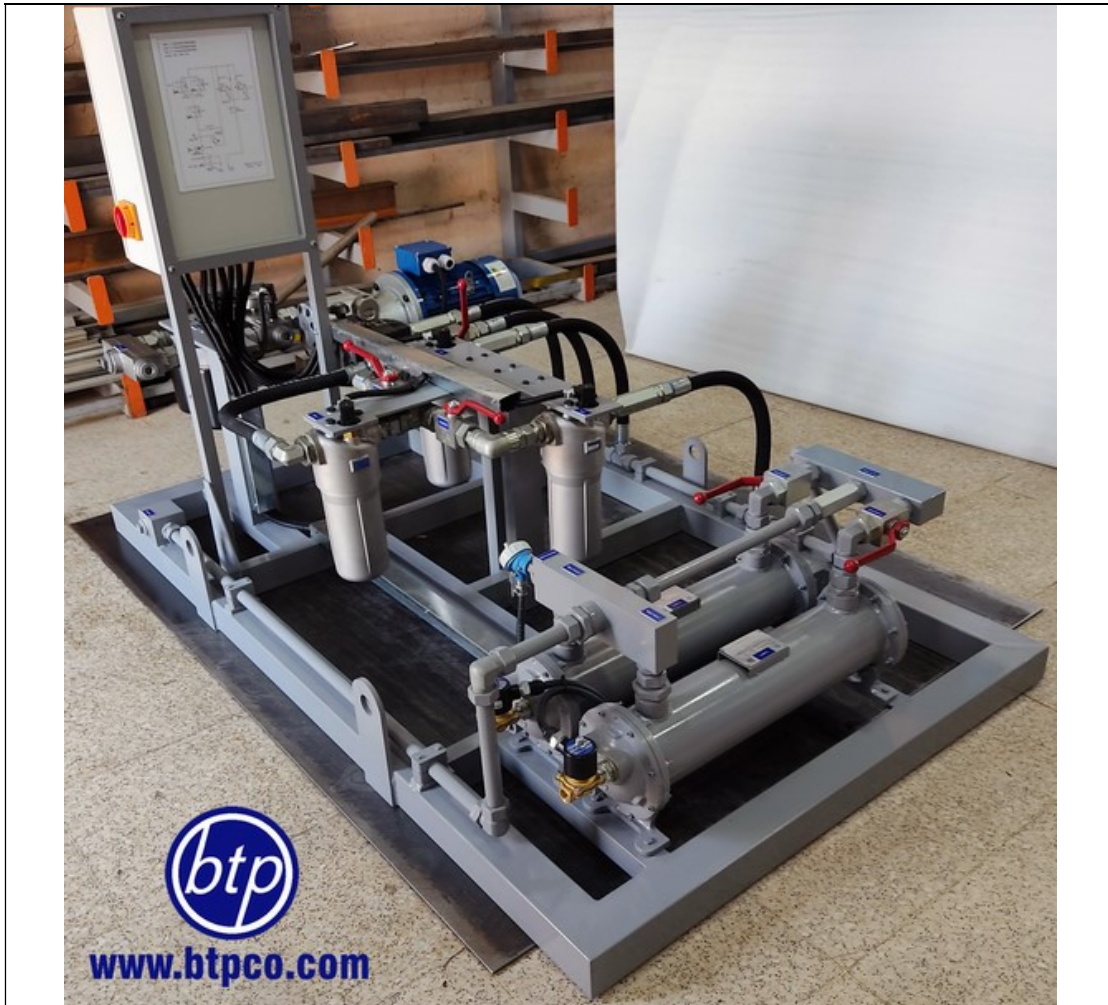
سیستم فیکس فیلتراسیون و خنک کن کاری روغن هیدرولیک با دبی 100lit/min
