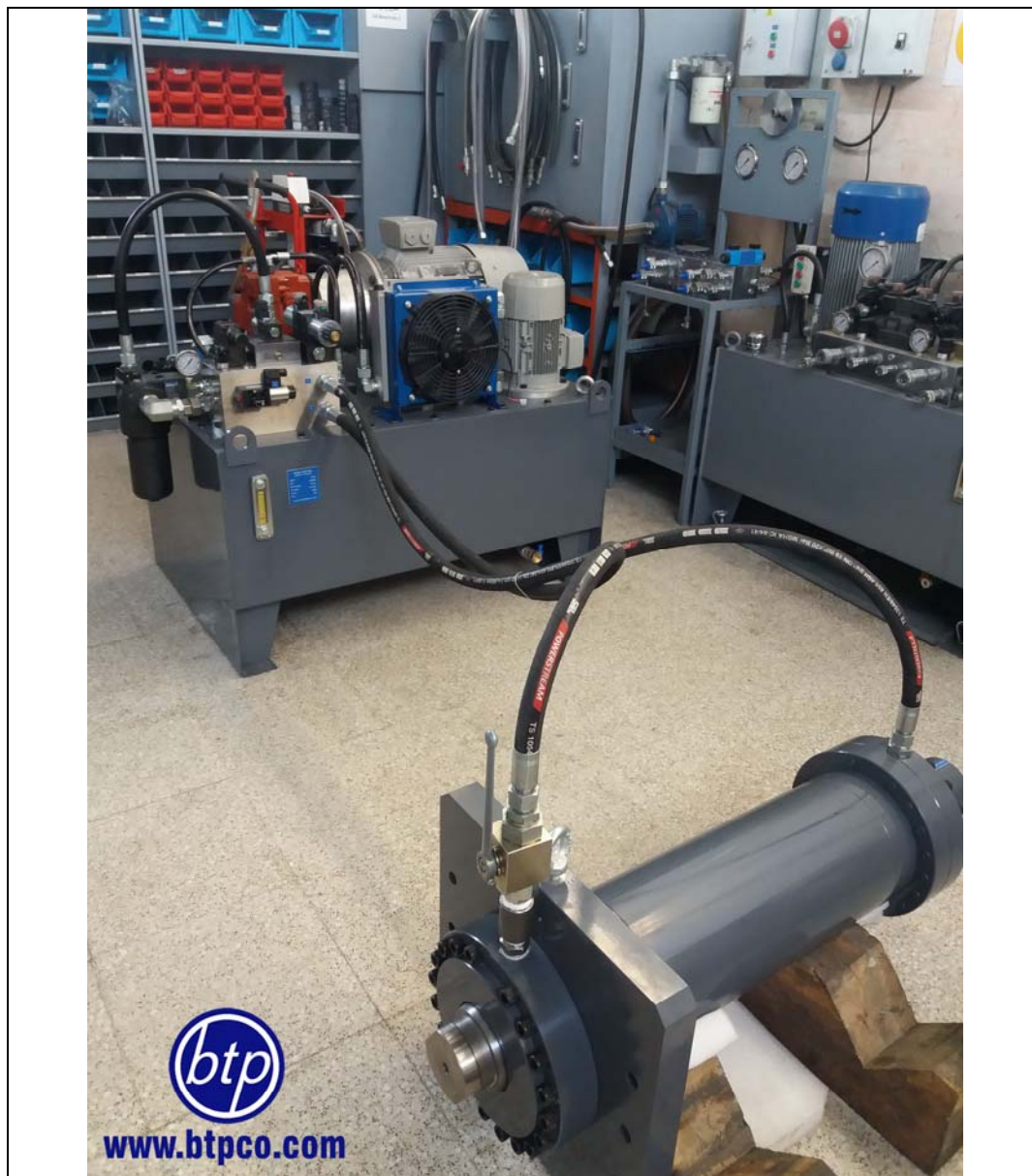
تست سیلندر هیدرولیک ۶۰ تن مجهز به خط کش دیجیتال و یونیت هیدرولیک با پمپ واریابل کواکسی و شیر کنترل فشار پروپورشنال
