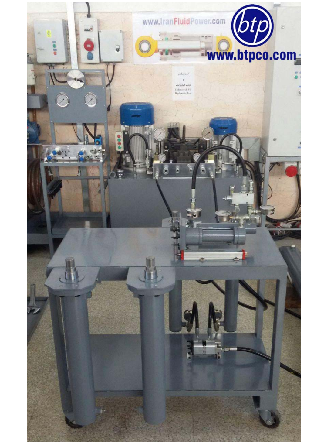
تست سنکرون سازی سیلندرهاى هیدرولیک با فلودیوایدردنده ای (استفاده از کانتربالانس جهت شبیه سازی نامتقارن بودن بار روی سیلندرها)
